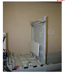
Le dessus (en acier) se relève sans aucune sécurité, alors qu'il fait un poids très important. Il est nécessaire de le laisser en position relevée, pour pouvoir déposer les papiers à compacter et accrocher les ficelles en plastique.
