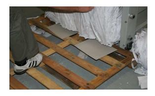
I faut tirer le balot, avec difficultés, vu son poids conséquent. Il faut au préalable essayer de déposer sur la palette, des cartons récupérés également aux éditions, pour éviter aux balots de trop s'accrocher à la palette.
